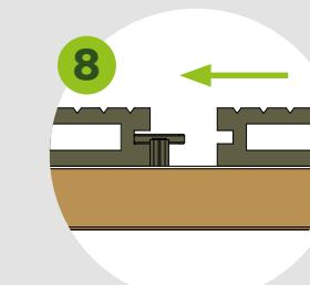
Ieder volgend terrasdeel bevestigen met montageclips. Boren met 2,5 mm boor.
