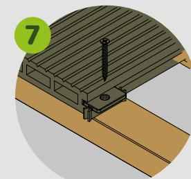
Clips vastschroeven in de onderregel. Visser les clips dans les lambourdes.
