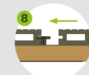
Ieder volgend terrasdeel bevestigen met montageclips. Boren met 2,5 mm boor.
