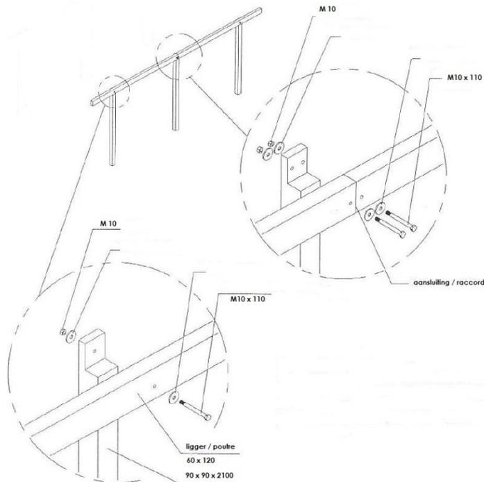
**4. Dwarsbalken voor dakconstructie bevestigen met L ijzers**
