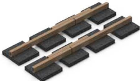
On peut également effectuer une jointure par le centre, en respectant un écart minimal de 10 mm entre les deux faces. On placera à côté une lambourde d'une longueur de deux fois la largeur d'une lame + 10 cm.
