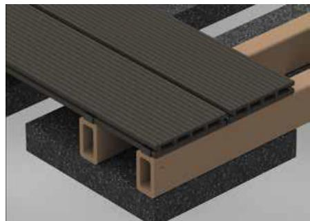
Let erop dat u de planken parallel legt, en bevestig deze op elke onderligger met de bijbehorende montageclip. Steek nu de montageclip in de groef en trek de schroef lichtjes aan, zonder dat u spanning op de clip zet. Schuif nu de tweede plank in de montageclip en bevestig deze weer met een montageclip; zet de vorige montageclip nu vast. Ga hetzelfde te werk bij de montage van alle andere planken.
