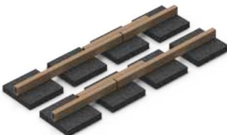
Bij de andere variant van een stotende onderconstructie kunt u de onderliggers achter elkaar leggen, maar wel met een minimale afstand van 10 mm tussen de twee kopse kanten. Op het stootpunt brengt u aan de zijkant een extra onderlijker aan, met een minimale lengte van twee keer de plankbreedte + 10 cm.
