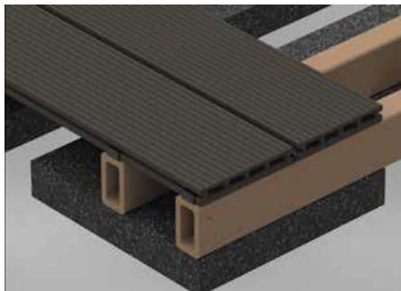
De terrasplanken moeten in principe aan beide kanten met een montageclip worden bevestigd aan elk oplegpunkt op de onderconstructie. Let er daarbij op dat de terrasplanken volledig worden ondersteund. De planken mogen aan de zijkanten maximaal 2 cm boven de onderconstructie uitsteken.
