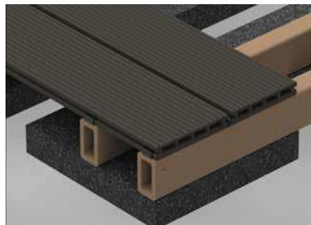
Une fois cette opération terminée, serrez plus fortement le clip d'assemblage précédent. Pour fixer les lames suivantes, répétez l'opération décrite ci-dessus. Les lames de terrasse doivent être systématiquement fixées des deux côtés sur chaque point d'appui de la sousconstruction à l'aide des clips. Veillez à ce que l'ensemble repose sur toute la surface de la sous-construction. Le débordement maximal autorisé de la lame par rapport à la lambourde est de 2 cm.
