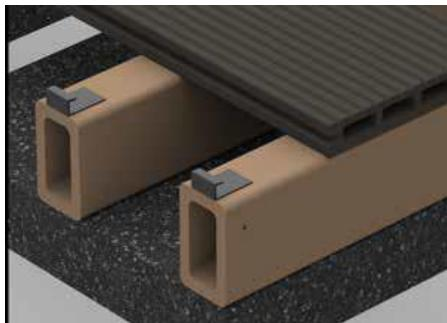
Préparez systématiquement toutes les fixations à visser en perçant des avanttrous. La visseuse doit être réglée sur un couple bas, afin que la vis ne traverse pas le clip.
