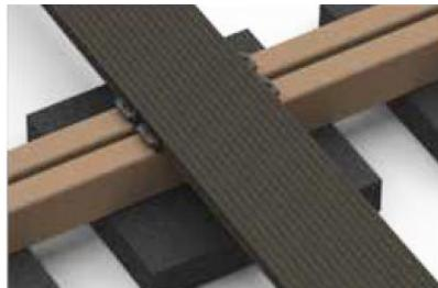
La lame placée sur la jointure devra être fixée sur les deux supports afin d'assurer une transmission des forces régulière.
