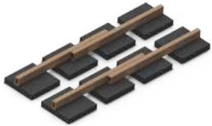
Si la longueur des lambourdes est insuffisante, effectuez une jointure. Pour cela, il suffit de placer une deuxième lambourde à côté de la première de façon à ce qu'elles soient côté à côté sur une longueur d'au moins deux fois la largeur d'une lame + 10 cm.
