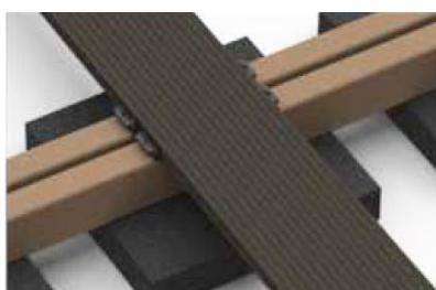
In principe moet ieder stootpunt in de onderconstructie zodanig worden aangebracht dat een plank bij een stootpunt aan allebei de onderliggers kan worden bevestigd. Zodoende bent u verzekerd van een gelijkmatige krachtoverbrenging.
