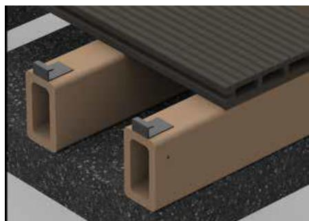
Voor het bevestigen van de eerste plank gebruikt u rvs eindclips. Bevestig deze op de onderliggers. Vervolgens schuift u de eerste plank met de groef in de eindclips.
