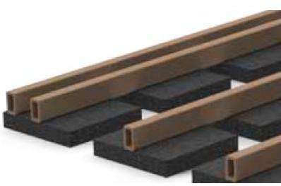
Les lambourdes seront posées au départ et à l'extrême respectivement en double, avec un écart minimal de 2 cm entre les deux, afin d'éviter une charge excentrique des dalles en béton.
