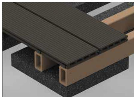
Veuillez à ce que les lames soient posées parallèlement, et fixez-les sur chaque lambourde à l'aide du clip correspondant. Placez le clip d'assemblage dans la rainure et serrez légèrement la vis, en veillant à ne pas placer le clip sous tension. Enfoncez alors la seconde lame dans le clip d'assemblage et fixez-la à l'aide d'un autre clip d'assemblage.
