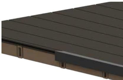
Bij de montage van de afdekkatten in de lengterichting legt u onder de planken een onderconstructie (bevestig de onderbouw aan de ondergrond). Daarna bevestigt u het hoekprofiel met schroeven aan de onderbouw. Als er niet voldoende afwatering mogelijk is, moeten de onderliggers worden onderbroken (afstand 10 mm). Waar nodig moet u het hoekprofiel in hoogte aanpassen.
