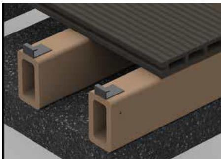
In principe moeten alle bevestigingen voor schroeven worden voorgeboord. Let erop dat u bij de schroefmachine een laag koppel gebruikt, zodat u de schroef niet door de klem heen trekt. Om afstotingen en het risico op breuken te voorkomen, moet u er bij het leggen op letten dat de planken aan de uiteinden nergens meer dan 2 cm boven de onderbouw uitkomen.
