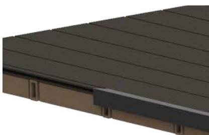
Dans le sens des lames (longitudinal), vissez les cornières de recouvrement sur la lambourde. Il est nécessaire avec les lambourdes creuses de poser des bouts de lambourdes dans la sous-construction (à fixer au sol), si le drainage n'est pas garanti il faudra les interrompre pour qu'il y ai un espace de 10 mm entre les lambourdes.
